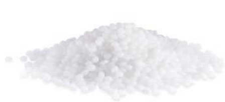
plastični granulat za elektropoliranje
