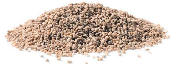
granulat orahove ljuske za visokosjajno suho poliranje
